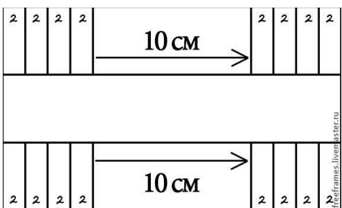
Сосредоточимся на прямоугольниках, которые получились посередине. В верхнем прямоугольнике по верхней стороне откладываем середину ( $10:2=5$  см), ставим точку. От этой точки с помощью линейки проводим линии в точки пересечения ближайшей горизонтали с двухсантиметровыми вертикальными линиями.
